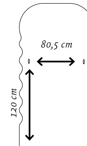
*Monter les chevilles à expansion sur le mur en face des crochets à l'arrière de la lampe/miroir.*
